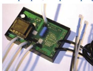
Микропроцессорный регулятор давления конденсации (MRDK) предназначен для поддержания давления конденсации в оптимальном диапазоне при работе кондиционера на охлаждение при низких температурах наружного воздуха (до -40°C).
