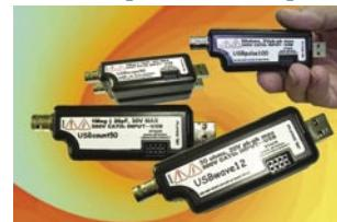
В миниатюрном исполнении — конструктиве USB флеш-накопителей — стали доступны осциллограф, генератор сигналов специальной формы, генератор импульсов и частотомер. Управление приборами осуществляется с ПК через интерфейс USB 12 Мбит/с. Приборы имеют один канал со стандартным BNC-разъемом. Возможно объединение до 4 модулей для совместной синхронной работы. Имеется гальваническая развязка по категории III 300 В. Масса приборов — 42 г.
